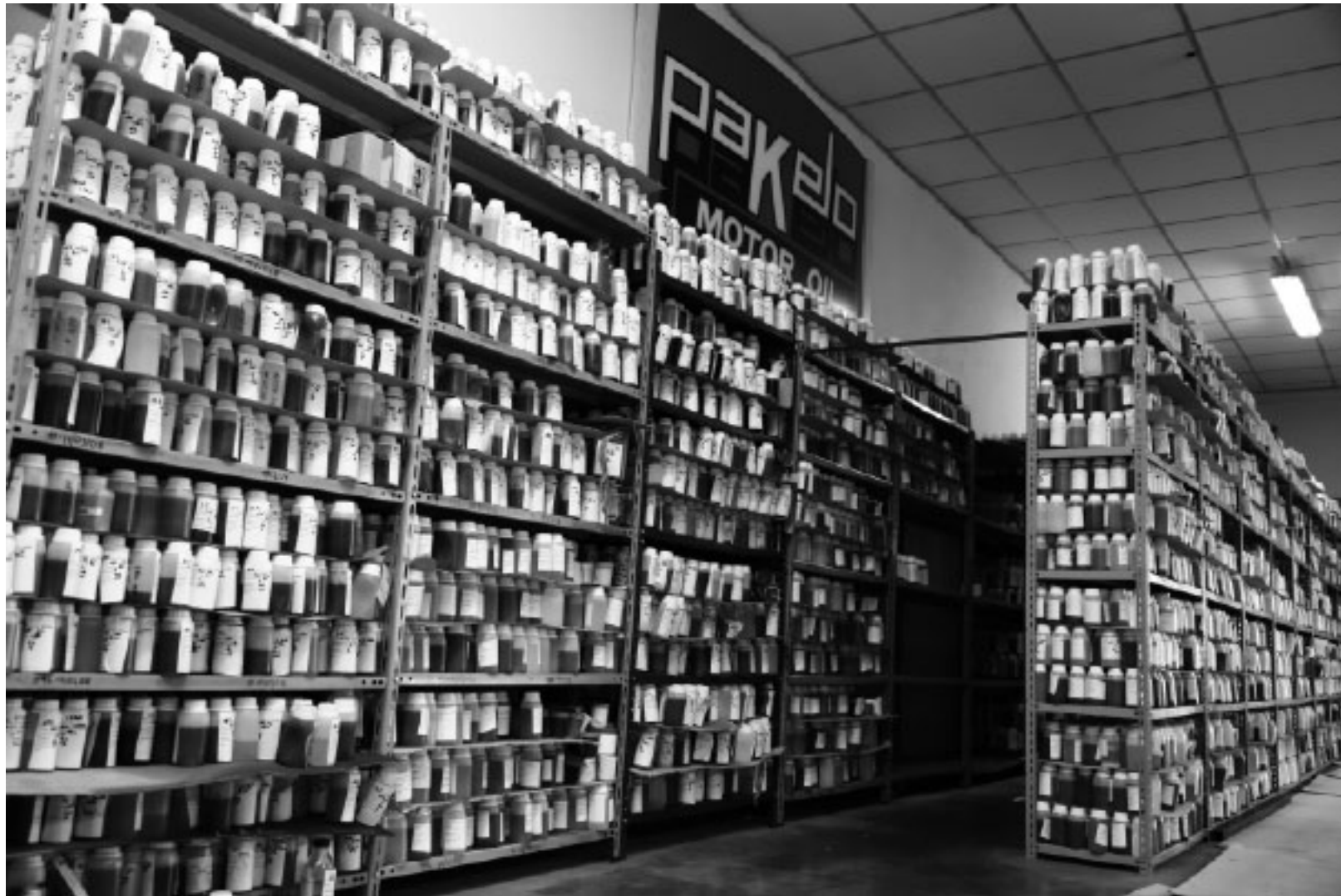
Archivio dei controcampioni storici: un flacone per ogni produzione relativa agli ultimi cinque anni.
